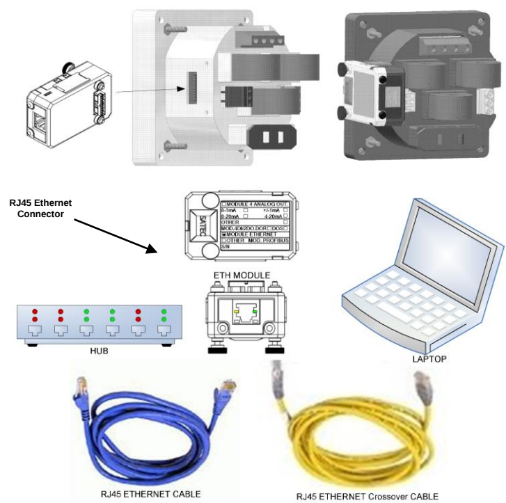
Рисунок 2-21 Подключение прибора через порт Ethernet.
